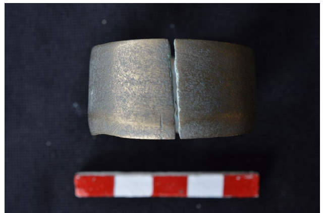
ภาพที่ 14 กาลิสำริดที่มีส่วนผสมของดีบุกในปริมาณสูง (high tin bronze) ภาพถ่ายโดย ธีรศักดิ์ ธนูศิลป์ (CC BY-NC 4.0).
